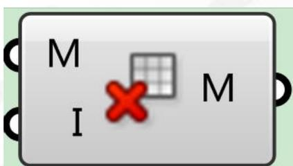
Mesh Shadow: 计算网格在光线 (向量) L 下在工作平面 P 上的阴影轮廓输入端
