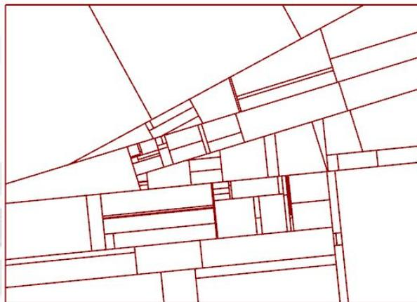
Facet Dome: 根据点集 P 拟合球面 D, 并生成外切 D 的多边形集(切点为 P 在球面上的投影)
