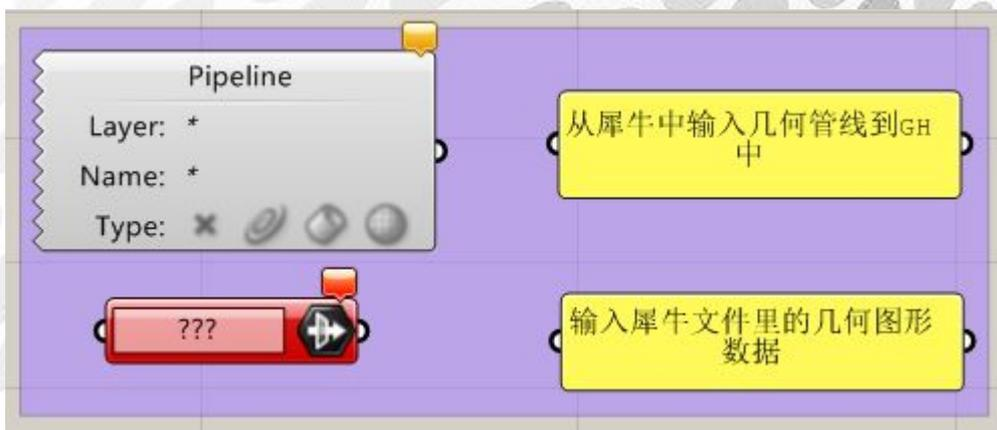
Geometry Pipeline:从犀牛中输入几何管线到 GH 中
