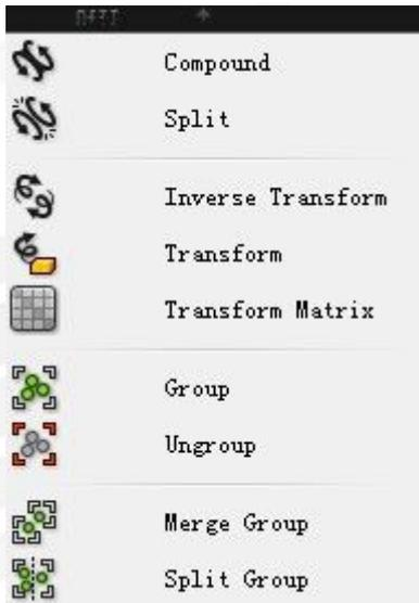
Compound: 合并变形，可以将两个单独的变形条件（如变高，变胖）合并成一个。
