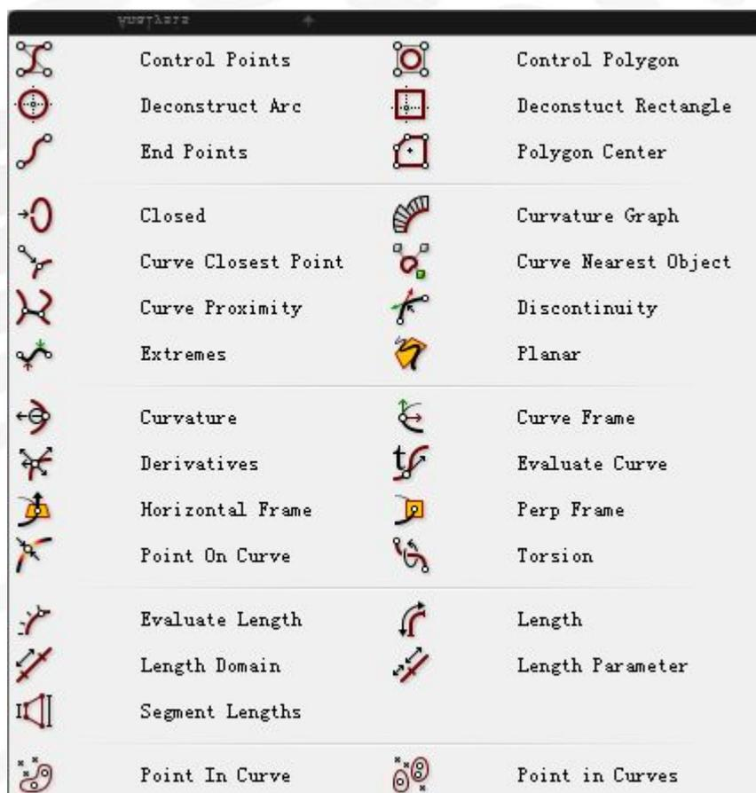
Control Point: 得到一个 Curve 的控制点和节点
