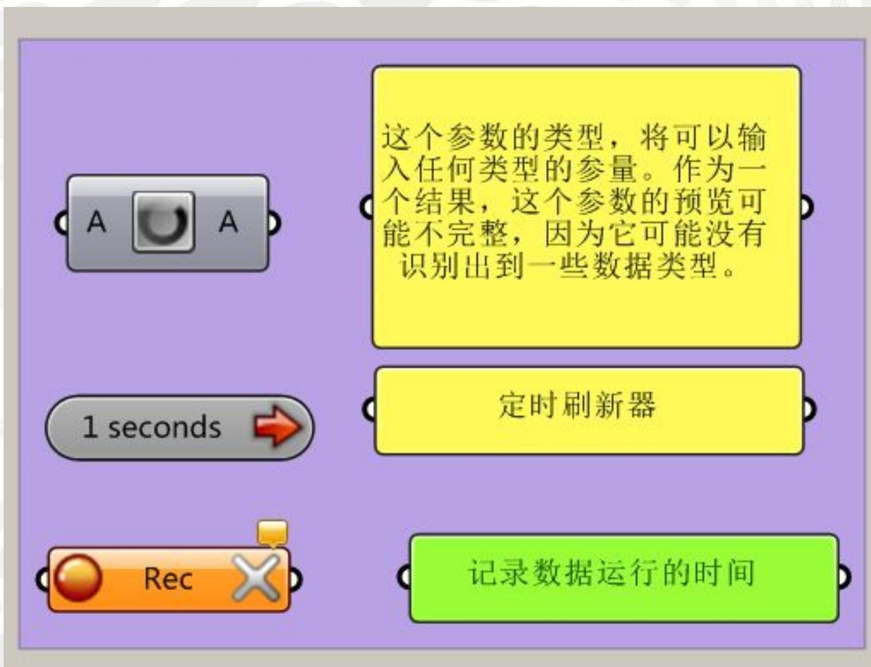
Data Dam:这个参数的类型，将可以输入任何类型的参量。作为一个结果，这个参数的预览可能不完整，因为它可能没有识别出到一些数据类型。
