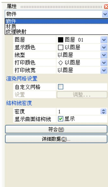
图 9.4: 物件属性工具面板
