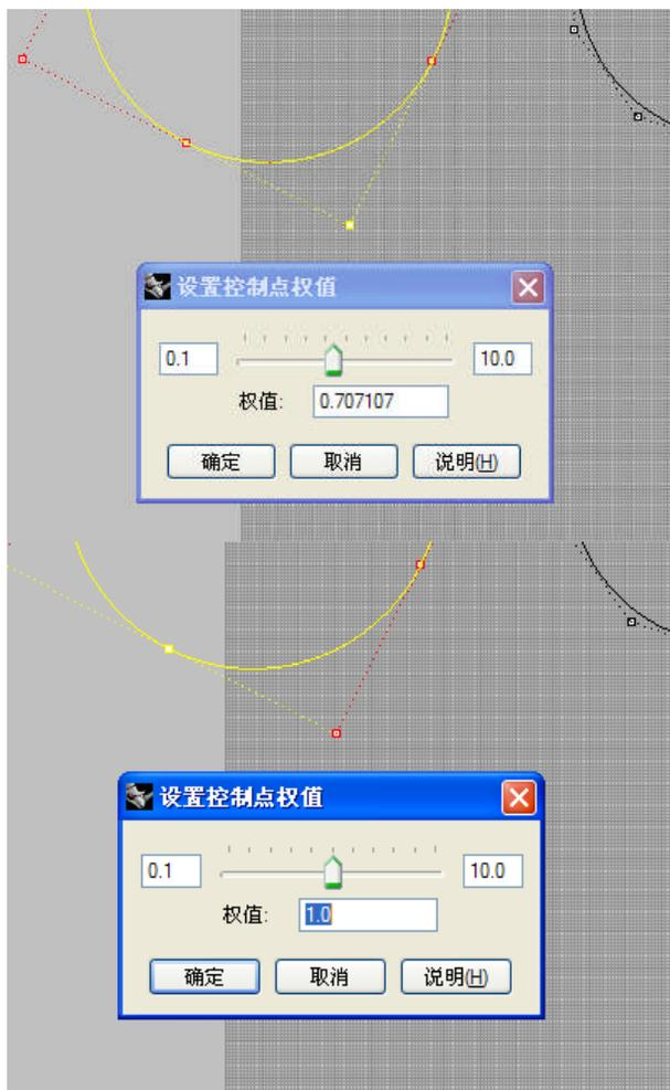
图 4.25A/B: 第一个圆上 CV 点的权重。
