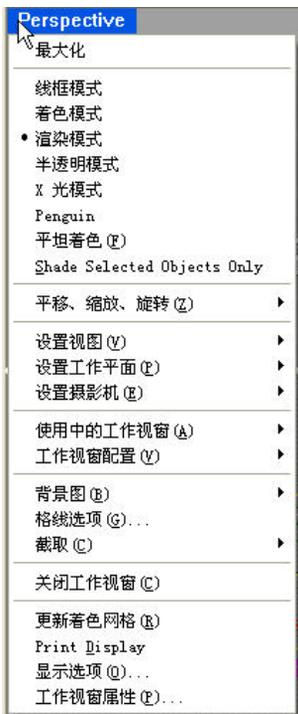
图 2.11: 右键视图标签进行视图设置。
