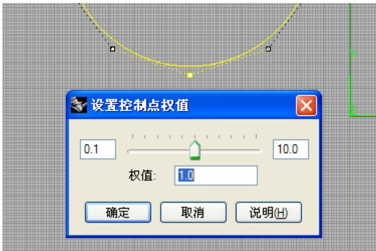
图 4.26: 第二个圆上的 CV 点权重。
